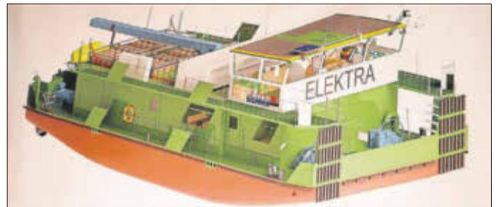
Unter Berücksichtigung der langen Transportfahrten, die mehrere Tage andauern können, wurden Aufenthaltsräume, Kammer und Kabinen für die Übernachtung der Besatzung entworfen. Der Maschinenraum wird hierbei durch einen großen Raum ersetzt, der die Lithium-Ionen-Batterien aufnimmt. Zusätzlich soll ein großer Raum die Schalttechnik unterbringen. Dort wird das Zusammenspiel zwischen Energie bereitstellen und Energie speichern geregelt.
